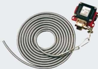
Tahový spínač s tažným lankem z umělé hmoty Možná vodorovná nebo svislá montáž, tlakově odlitá hliníková skříň IP 65, délka lana 4 m.
