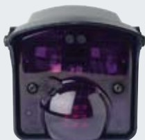
Komfort radaru / detektoru přítomnosti Radarové rozpoznání pohybu a přítomnosti pomocí infračerveného rozpoznání. Rychlé a cílené automatické otvírání vrat. Spolehlivé zajištění předpolí. Do výšky max. 6 m. Při vysoké vzdušné vlhkosti a ve venkovním prostředí je použitelný jen radar. Skříň: stupeň ochrany krytem IP 65.
